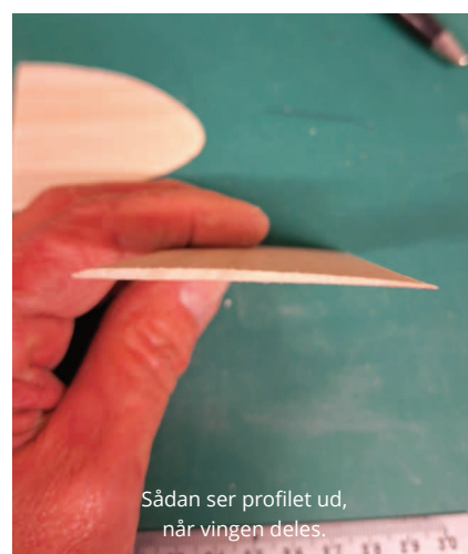
Profilet pudset i vingen. Opmærkning brugt som guide.
