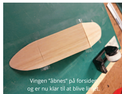
Vingen lægges med undersiden op og samles med tape.
